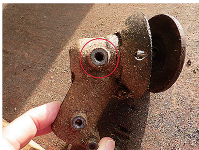
グリス注入箇所
